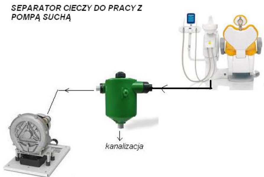
Rys 2. Usuwamy Mini separator znajdujący się w unicie stomatologicznym i łączymy ze sobą przewody ssące. Instalujemy zbiornik separacyjny przed pompą suchą. W ten sposób zamieniamy system ssania suchego na pół-mokry. Zbiornik wyłapuje wszystkie zassane płyny przed pompą. Zatrzymanie pompy pozwala zrzucić grawitacyjnie ciecz znajdującą się w zbiorniku. Ten system przeznaczony jest do pracy tylko z pojedynczym unitem stomatologicznym
